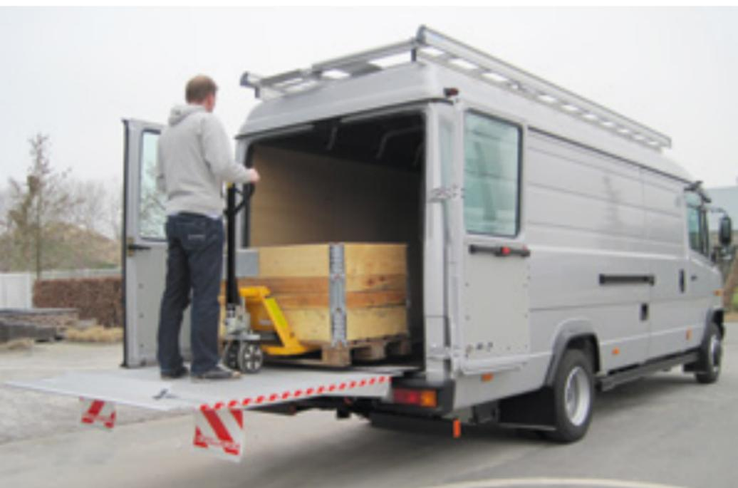
La DH-LC.15 offre 1500 kg di capacità di sollevamento per i **furgoni originali con capacità più alte** da 4.5 fino 7.5T PTT (e.g. Mercedes Vario, Iveco Daily,...).
